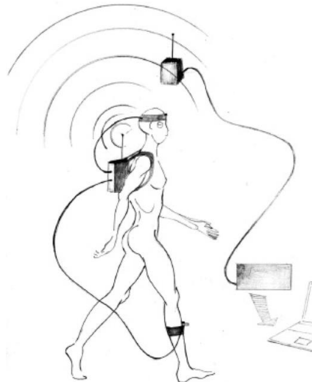
Figura 18. Esquema del funcionamiento de un equipo de acelerometría inalámbrico con dos acelerómetros (tibia y cabeza) (Pérez-Soriano y Llana, 2015).
