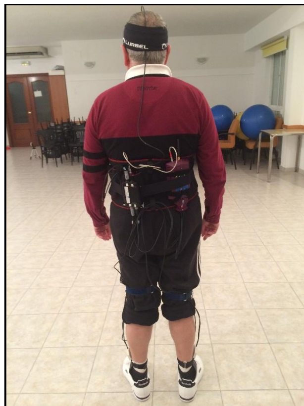
Figura 19. Participante instrumentado con sistema de medición de presiones plantares Pedar-X (Novel®) y con sistema de acelerometría Acelsystem (Blautic®)
