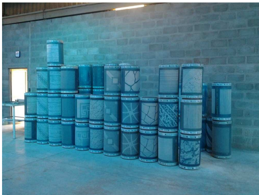
Figura 34 – Foto dos estampas serigráficas utilizados no processo de esmaltação e decoração de revestimentos na Cerâmica Almeida – Santa Gertrudes/SP Autora: Keity Kristiny Vieira Isoppo, 2014.
