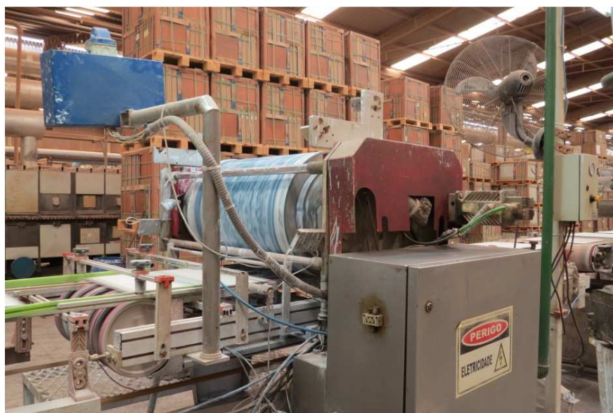
Figura 25 – Foto da serigráfica rotativa Rotocolor produzida pela empresa italiana System Autora: Keity Kristiny Vieira Isoppo, 2014.
