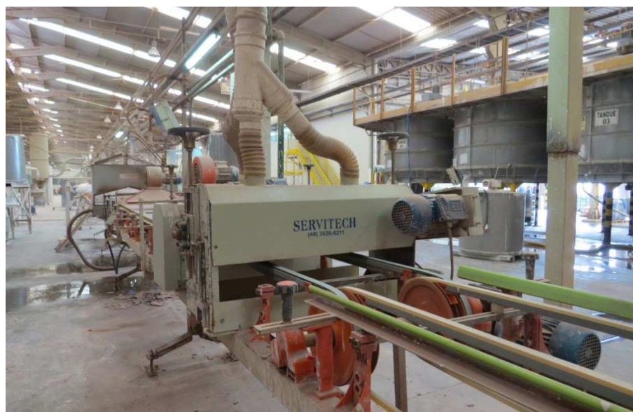
Figura 55 – Foto dos equipamentos e da linha de esmaltação da Servitech na planta industrial da Angelgres em Criciúma/SC
