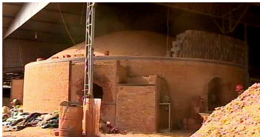
Figura 7 – Forno intermitente “tipo garrafão” atualmente utilizado somente na produção de cerâmica vermelha (telhas e tijolos).
