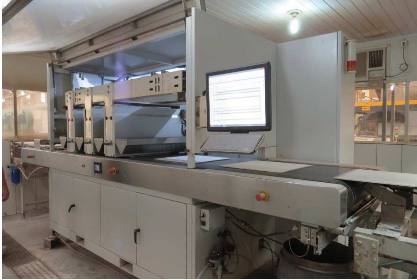
Figura 27 – Foto da impressora digital da Angelgres Revestimentos Cerâmicos Autora: Keity Kristiny Vieira Isoppo, 2016.
