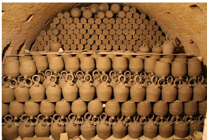
Figura 6 – Forno Moruno de uma Cerâmica Artesanal (Alfarería) localizada em Alicante (Espanha). Fonte: LA NAVÁ ALFARERÍA ARTESANAL. Disponível em: < http://www.alfarerialanava.com/es/noticia/el-horno-moruno-de-nuestro-taller/1/#.WgNoqLWsOt8 >. Acesso em: 10 out. 2017.
