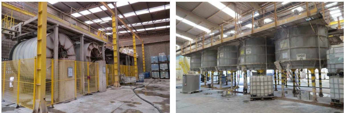
Figura 28 – Fotos do setor de esmaltação da Angelgres. À esquerda, moinhos para preparação dos esmaltes. À direita, tanques de armazenamento dos esmaltes Autora: Keity Kristiny Vieira Isoppo, 2017.
