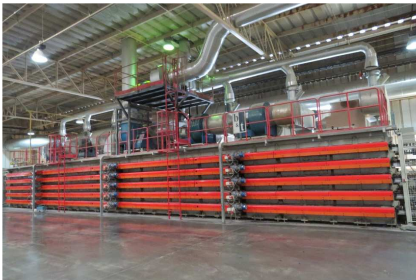
Figura 23 – Foto de um secador horizontal produzido pela empresa italiana Barbieri & Tarozzi (B&T) Autora: Keity Kristiny Vieira Isoppo, 2014.
