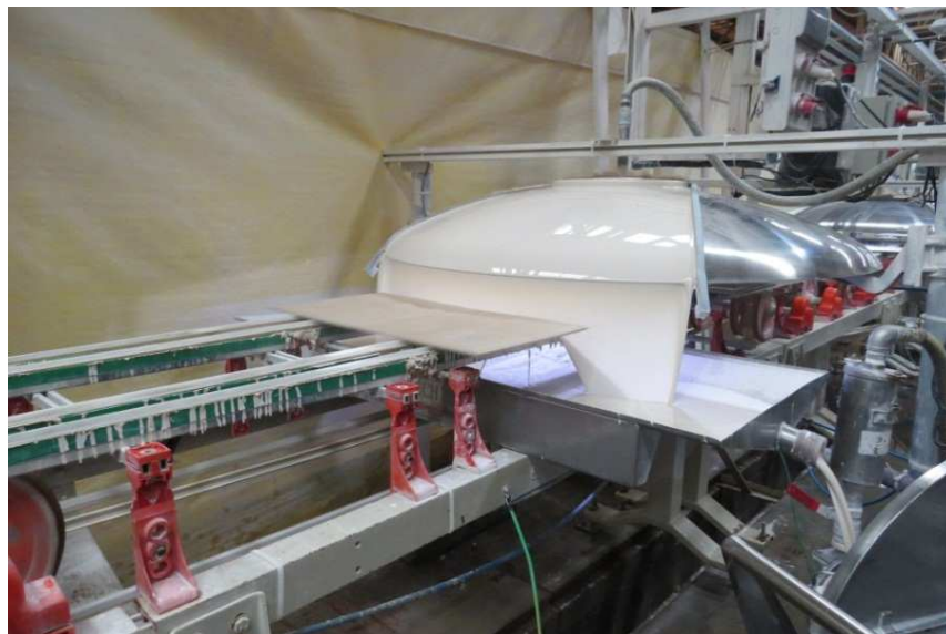
Figura 24 – Foto de parte da linha esmaltação - aplicação da primeira camada de engobe Autora: Keity Kristiny Vieira Isoppo, 2014.
