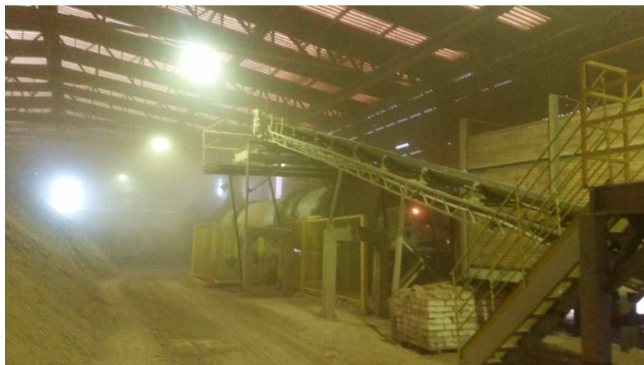
Figura 20 – Foto do setor de preparação da massa com tecnologia de moagem via seca da Angelgres localizada em Criciúma/SC
