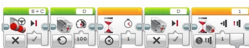
Figura 4.9: Bloque de instrucciones de parada y arranque.
