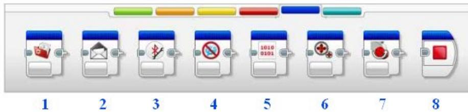
Figura 3.20: Bloques avanzados: 1 Acceso al archivo 2 Mandar mensaje 3 Conexión Bluetooth 4 Mantener activo 5 Valor del sensor 6 Motor sin regular 7 Invertir el motor 8 Detener programa.
