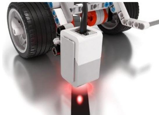
Figura 4.4: Sensor de color (foto sacada del manual de Lego).
