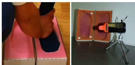
Figura 8. Creación del molde de la huella plantar (izquierda) y escaneo 3D del molde con el “smartphone” (derecha) (Pribanić et al., 2019).
