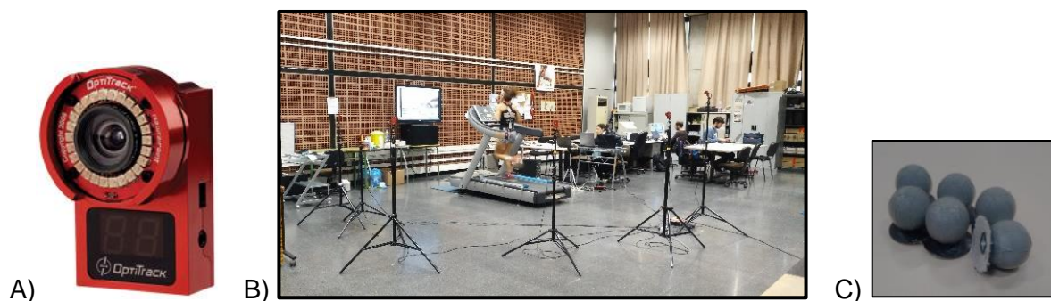
Figura 40. Sistema de captura del movimiento Optitrack. A) Cámara Flex 3; B) Disposición de las cámaras en el laboratorio; C) Marcadores.
