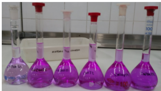
Batería de patrones para construir la recta de calibración en el método piridina- ácido barbitúrico. Fuente: Archivo Ricardo Pérez Sanz.
