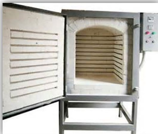
Figura 169. Horno eléctrico “mufla” para cocinar barro que Pérez Contel instaló en el Instituto Josep de Ribera de Xàtiva.
