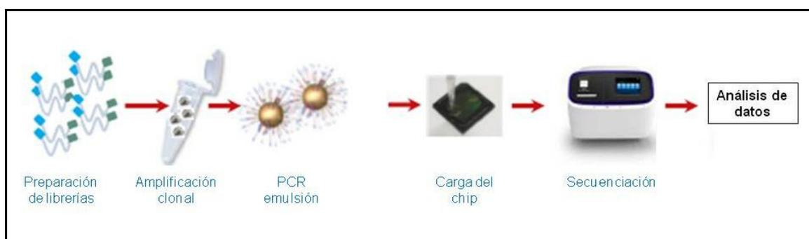
**Figura 11.** Esquema del proceso de preparación de las librerías y su secuenciación.
