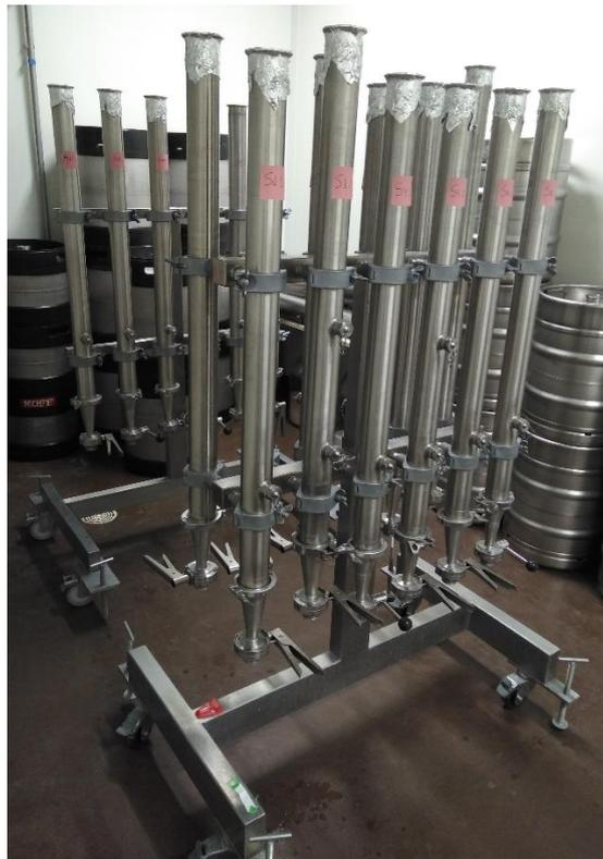
**Figura M.1** Recipientes de fermentación cilíndricos de acero inoxidable de 2 L donde se llevaron a cabo las fermentaciones a escala piloto (1.5 L).
