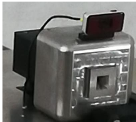
Figura 10.6. Imagen de la posición relativa de las dos cámaras, la visible situada sobre el colimador de tungsteno de la cámara gamma.
