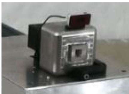
Figura 9.2. Acoplamiento físico de la cámara visible y Gamma GUALI I
