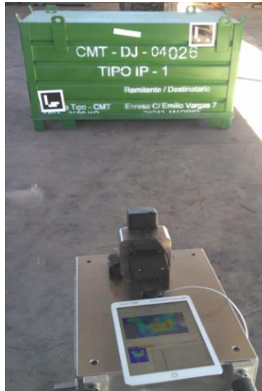
Figura 10.3. Medida con GUALI I de un contenedor con dos arucos ubicados en el mismo.
