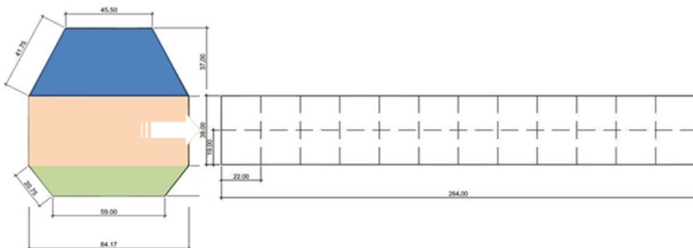
Figura 6.3: Segmentación virtual llevada a cabo del cilindro central de la hormigonera.
