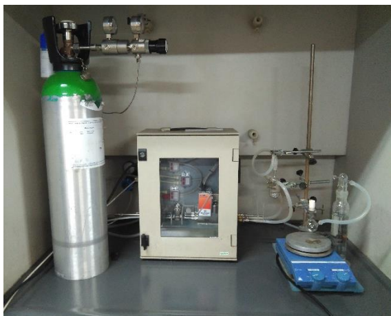
Figura 8.1. Sistema de caudalímetros empleado en las medidas con gases. A la izquierda se observa la bala del gas reactivo, en el centro, el gabinete que contiene los caudalímetros y la electrónica de control, y a la derecha, se encuentra el recipiente de mezcla de gases, el matraz de burbujeo sobre una placa agitadora y una trampa de gases con una disolución capaz de capturar el gas utilizado ( \text{Na}_2\text{CO}_3 saturado, generalmente).
