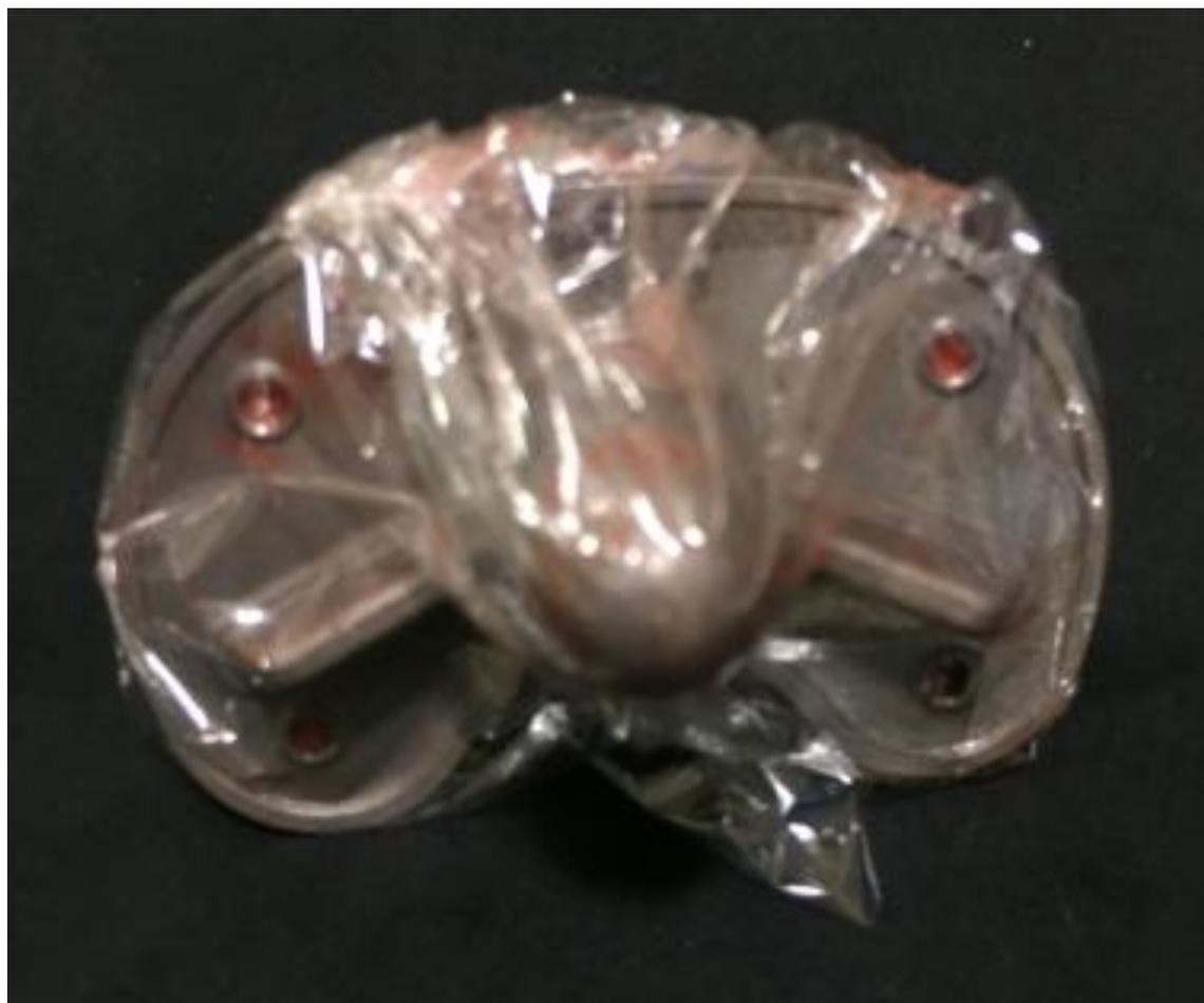
Figura 20. Bandeja tibial metálica recubierta con una capa de plástico de biofilm®, para impedir la adherencia del cemento al metal y facilitar la extracción de las bandejas una vez fraguado el cemento.
