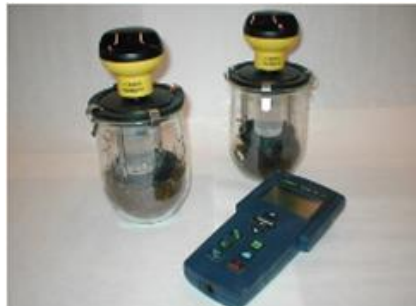
Figura 3.4.4. Equipo de respirometría y sensor de lectura.
