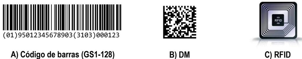
**Figura 3.4.** Sistemas transportadores de información para el control de cualitativo.
