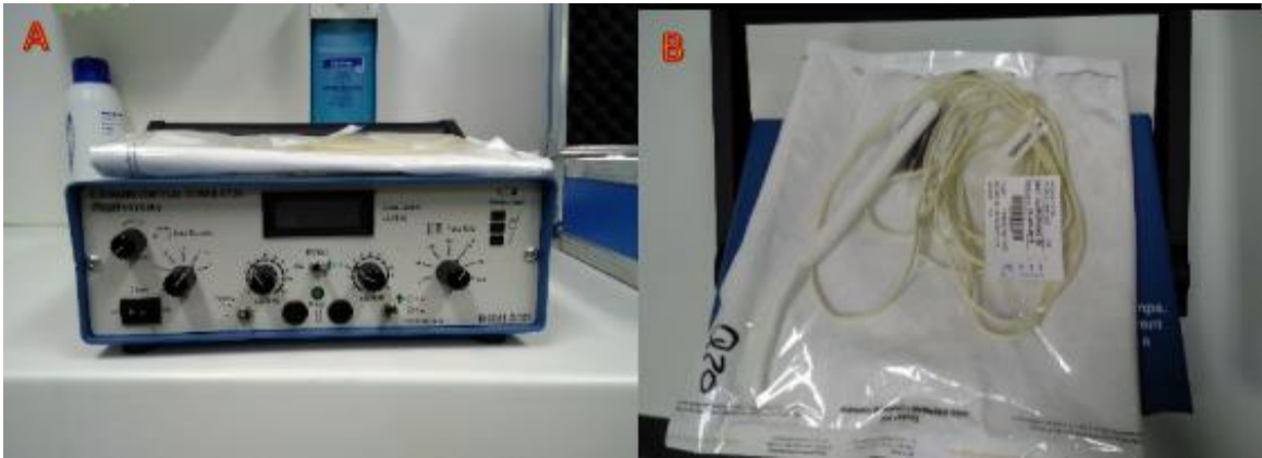
Figura 7. A. Estimulador cortical de Ojemann para el mapeo intraoperatorio. Es un instrumento portátil en el que se puede seleccionar una amplia variedad de salidas de corriente constante y su duración. En la pantalla se muestra el valor pico de corriente seleccionada. Mediante el interruptor de polaridad se puede escoger entre pulso positivo o negativo. B. Electrodo bipolar estéril para el estimulador cortical de Ojemann. Sus puntas son de carbono con una separación de 5 mm.
