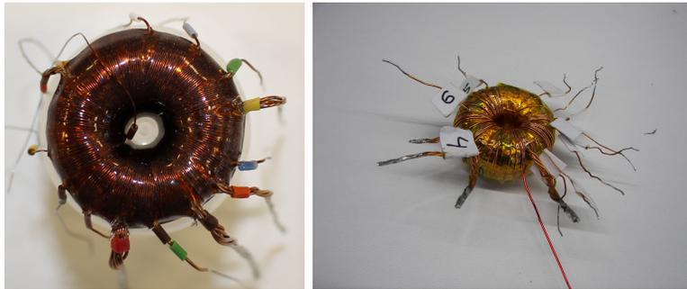
**Figura 1.9:** Dos prototipos diferentes de InAc con siete inductancias con valores inductivos diferentes, donde todas ellas son bobinadas sobre un núcleo toroidal de MPP. Sus valores de acoplamiento son altos y son empleados en prototipos del PCM de SO/PHI.
