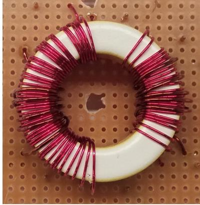
**Figura 2.18:** Inductor acoplado con 5 inductancias bobinadas en un núcleo toroidal de polvo de hierro. Se bobinan tres inductancias a la vez en el lado izquierdo y las dos restantes en el lado derecho, ambas con un buen acoplo. Y entre ambos lados, no presentan un buen acoplamiento.
