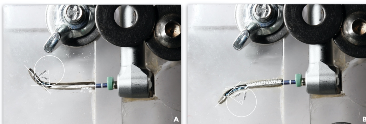
Figura 18. Conductos artificiales utilizados en el estudio de la resistencia a la fatiga cíclica estática. (A) Conducto 1. (B) Conducto 2.
