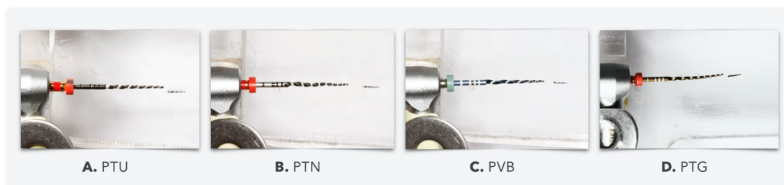
Figura 19. Detalle de las limas fracturadas y de los fragmentos fracturados. (A) Lima Protaper Universal F2. (B) Lima Protaper Next X2. (C) Lima Profile Vortex Blue 25/06. (D) Lima Protaper F2.
