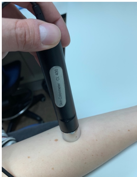
Figura 18. Toma de medidas de grados ITA con el equipo Colorimeter®.
