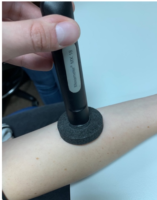
Figura 17. Toma de medidas de valores de eritema y melanina a través de la sonda Mexameter®.
