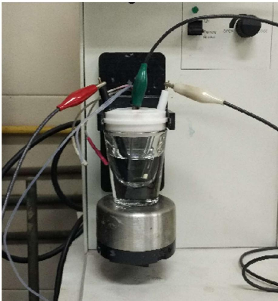
Figura 1.2. Configuración de celda de tres electrodos utilizada en voltamperometrías: electrodo de referencia (blanco), electrodo auxiliar (rojo) y electrodo de trabajo (verde).
