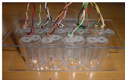
Para construir esta pila de hidrógeno se han unido varias células o celdas independientes para poder sumar sus intensidades. Cada una está formada por un tubo ancho de 3 cm pegado a una placa de metacrilato, a modo de recipiente de contención de un electrolito, en el que se insertan dos tubos más finos (de 1.2 cm), tapados en su parte superior mediante otra placa de metacrilato. Dentro de los dos tubos interiores hay colocados dos electrodos, cada uno en un tubo.
