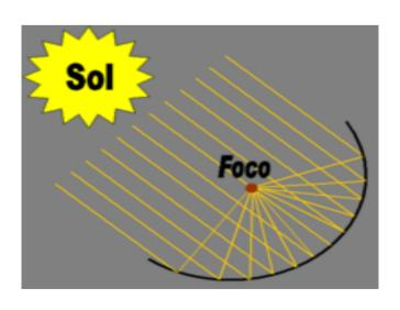
La dirección de propagación de una onda se representa mediante líneas que se denominan rayos y depende de la forma de la superficie en la que inciden. Cuando la forma de dicha superficie es parabólica todos los rayos que llegan paralelos al eje de la parábola se reflejan pasando por un mismo punto que se denomina foco. Esta es la propiedad fundamental en la que se basan todos los ingenios parabólicos.
