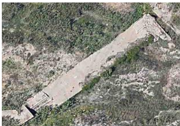
Imatge 13. L'assut de Rascanya és un exemple de presa derivació de planta recta. 170
