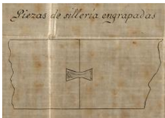
Imatge 60. Detall de les grapes projectades a l'assut de Vila-real. 651
