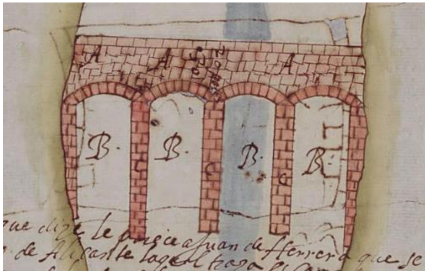
Imatge 28. Prototip del pantà de Tibi amb un possible sistema de volta. 224
