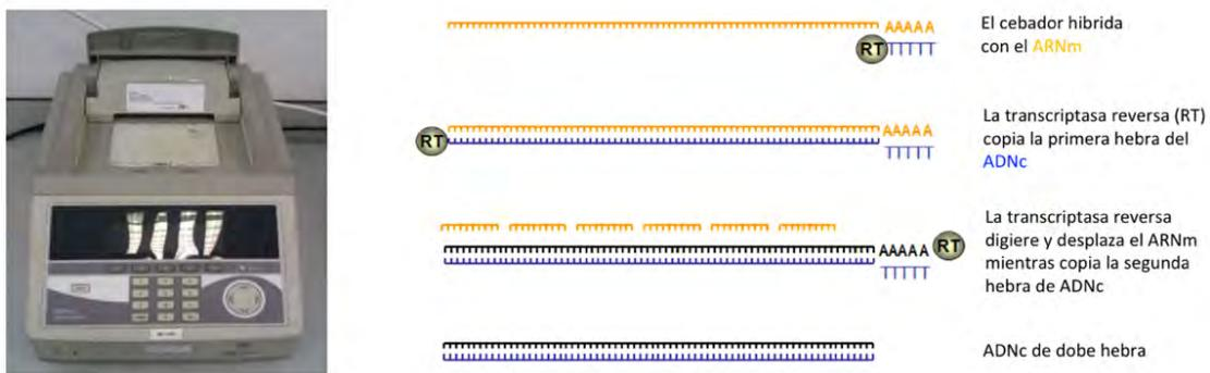
**Figura 22. Transcripción reversa.** La fotografía de la izquierda muestra el Termociclador 9800 Fast Thermal Cycler empleado para la reacción de transcripción reversa. La figura de la derecha muestra las etapas de la reacción.
