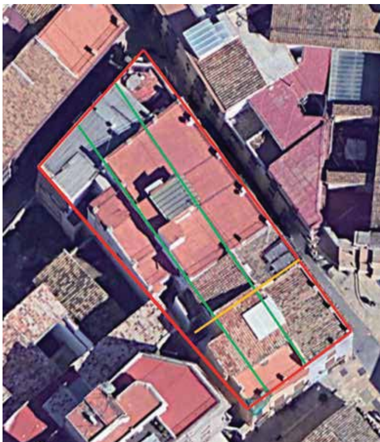
Fig.- 1. Vista aérea de la manzana e hipótesis estructural: en rojo muros de carga y en verde pórticos, amarillo linde de propiedad.
