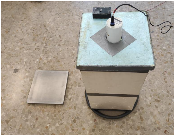
Figura 1. Montaje experimental para la realización de medidas con el método de la caja.
