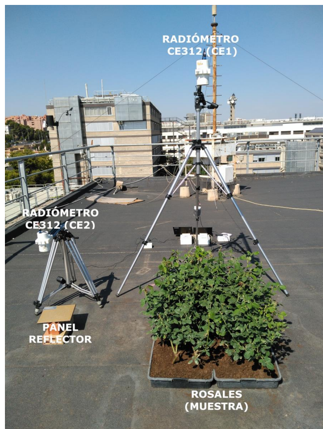
Figura 4. Montaje experimental establecido para las medidas radiométricas.
