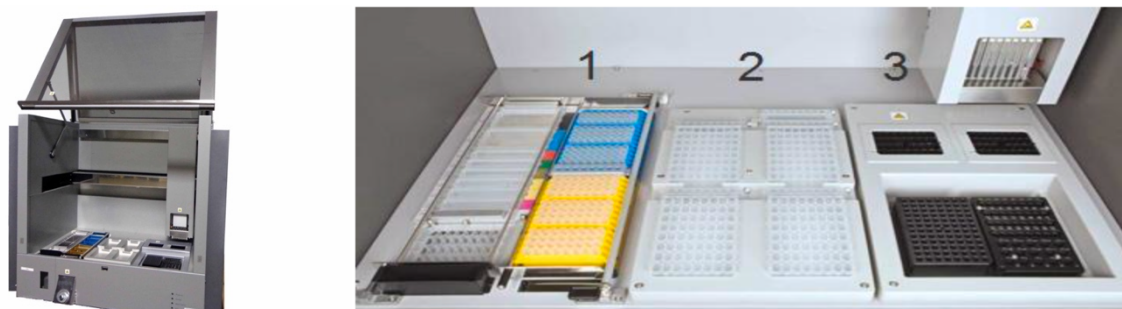
Figura M.6. Magnapure LC JE379 utilizado para la extracción del ADN del biofilm obtenido tras la incubación de la placa E-plate. Antes del procesado con el robot, las muestras fueron incubadas con un cocktail de enzimas para aumentar la lisis química.
