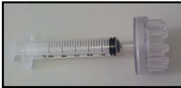
Figura 38. Conexión de la jeringa con el Dispensador del tipo pipeta múltiple circular.
