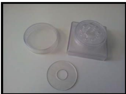
Figura 32. Piezas que constituyen el elemento Receptor (Base, Arandela, Tapa) del prototipo inicial del dispositivo POC.
