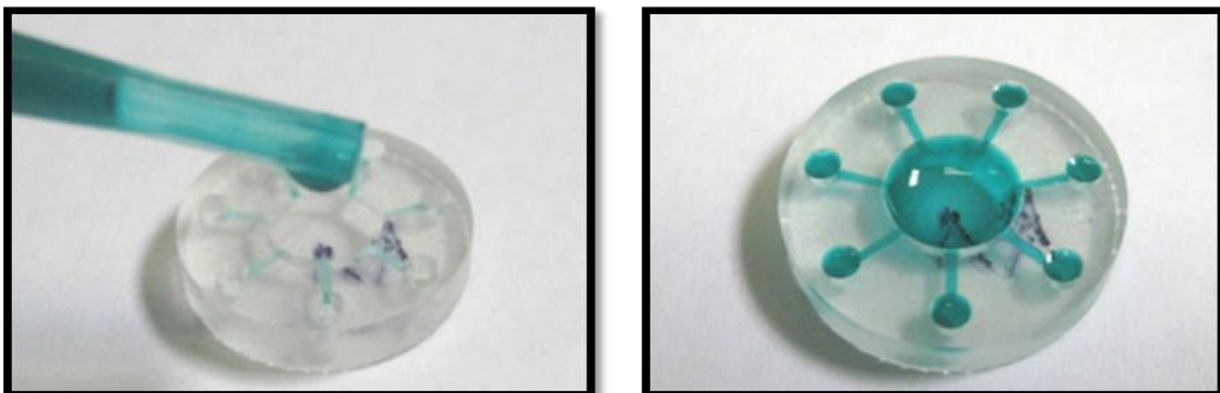
Figura 6. Prototipos rápidos del dispositivo POC con canales internos capaces de conducir la muestra por capilaridad.
