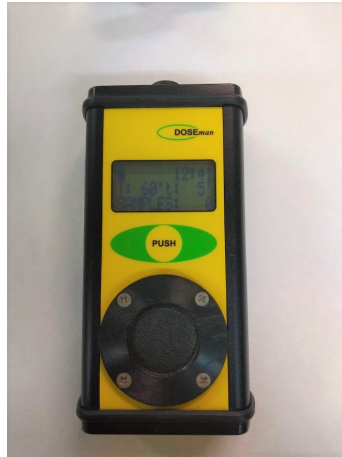
Figura 2.4: Detector electrónico de radón Doseman.
