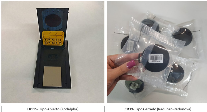
Figura 2.2: Detectores pasivos de tipo abierto y cerrado.
