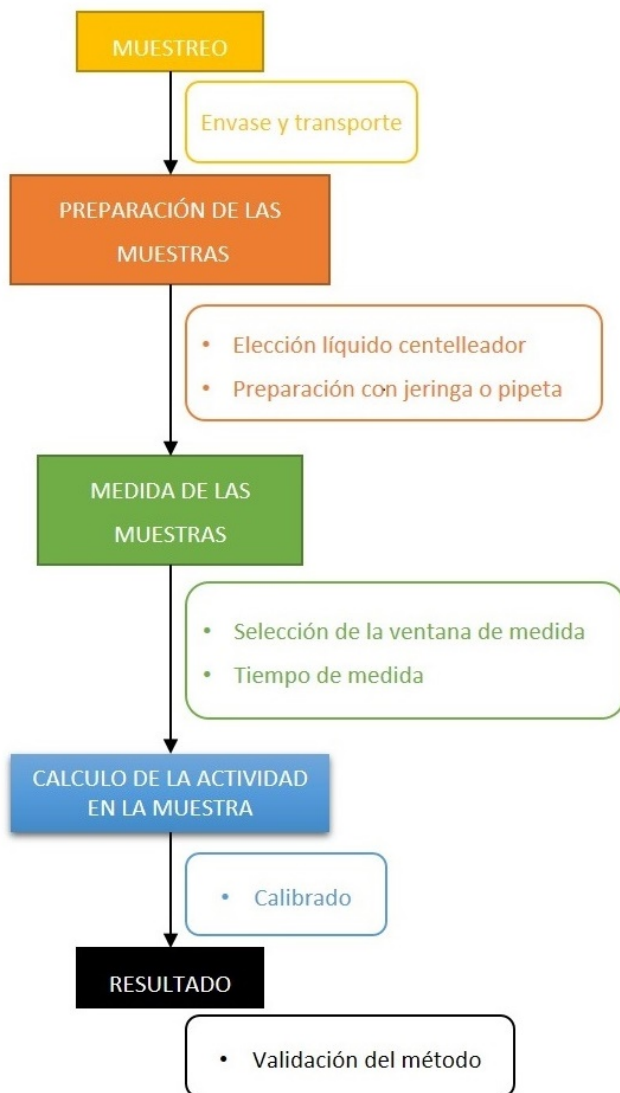
Figura 3.6: Diagrama de flujo del proceso de determinación de radón en agua por centelleo líquido.
