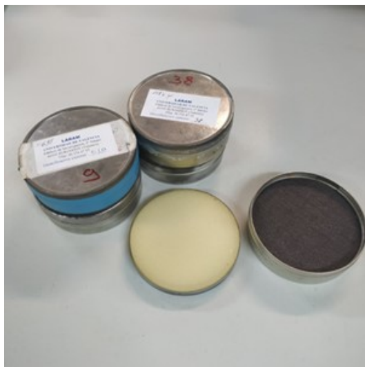
Figura 2.1: Canister de Carbón activo en exposición y cerradas.
