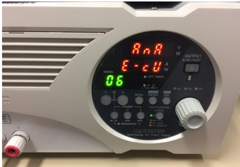
Figura 29. Opción del menú para que las fuentes de alimentación sigan la consigna del generador de señales como una señal en voltaje.
