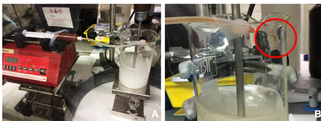
Figura 36. Montaje del sistema e inyección de la fase orgánica en la solución acuosa para la formación de las microsferas con partículas férricas. A: bomba de inyección y agitador, y B: inyección de la fase orgánica en la solución acuosa de PVA, donde se observa una gota de la de PLLA + partículas férricas a punto de caer en la fase acuosa.
