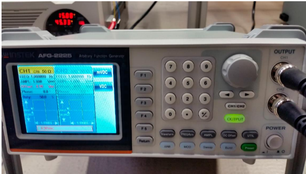
Figura 27. Sincronización invertida de las salidas del generador de señales para lograr un comportamiento alterno en cada uno de los módulos magnéticos.
