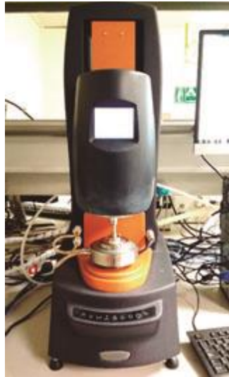
Figura 8. Reómetro utilizado para realizar el estudio reológico.
