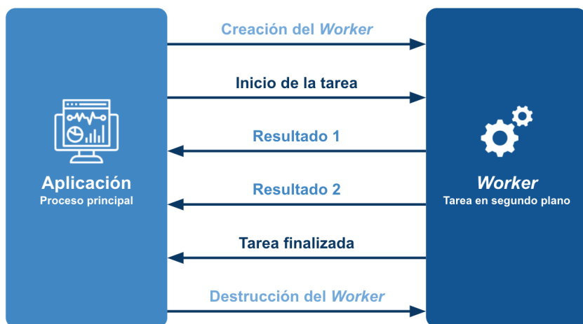
Figura 3.88. Flujo del funcionamiento de los Web Workers . El proceso principal (aplicación) crea un nuevo worker, al cual se le asigna una tarea a realizar (script). Los resultados de la ejecución de dicha tarea en el worker son comunicados a la aplicación, que, tras recibir el último mensaje de finalización de la tarea, destruye el worker.
