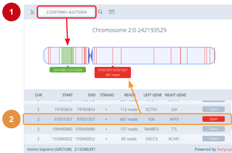
Figura 3.34. Esquema de la interactividad entre los módulos. La región introducida en la zona de búsqueda se traduce en un evento que es escuchado por la zona de representación gráfica, que responde resaltando la región introducida en el cromosoma (1). Por otro lado, cada fila de la tabla se conecta con la inserción representada en el ideograma, haciendo que al situar el ratón sobre cada una de las filas se resalta la inserción en el cromosoma (2).
