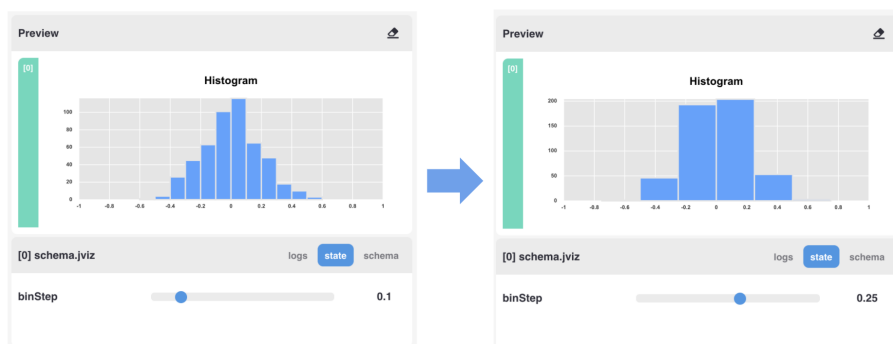
Figura 3.85. Modificación de la variable de estado «binStep» en el histograma, utilizando un manejador de tipo deslizador. El panel está conectado con el gráfico por medio de la API de jviz , de forma que, al modificar la posición del deslizador, este se comunica con el gráfico para darle el nuevo valor de esta variable, haciendo que el gráfico se actualice.
