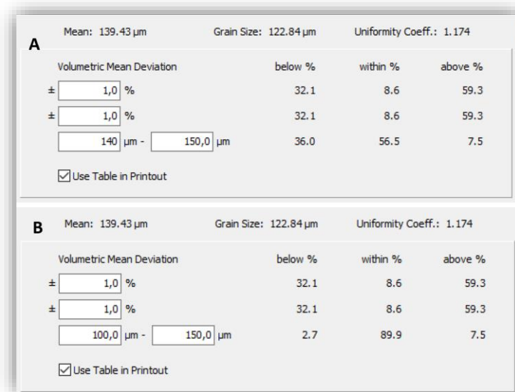
Figura 3.19. Concentración de valores detectados en el canal 140 (A) y el canal 100_150 (B). El tamaño medio de las partículas detectadas fue de 139,43 \mu\text{m} . El canal 100_150 nos sirvió como medida de control. Imagen obtenida con el programa PMA Software.
