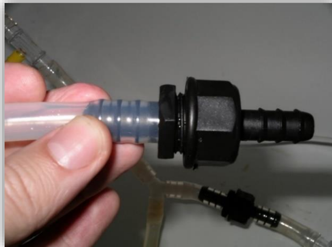
Figura 3.3. Porta filtros con malla de filtrado celular incorporada de 100 \mu\text{m} al final de T1 y T2.
