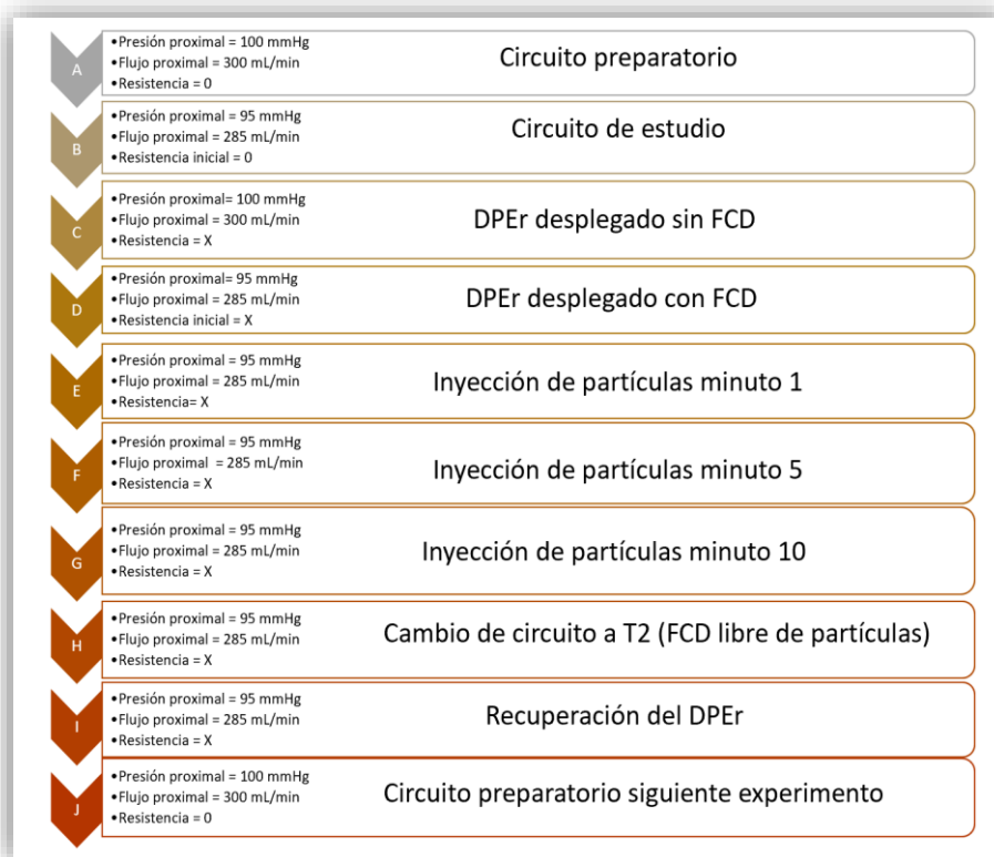
Figura 4.4. Fases del experimento. La modificación del flujo por el DPEr sin partículas se estudió en el circuito preparatorio (C) y en el circuito de estudio (D), cuya diferencia radicó en la presencia o no del filtro de control distal. DPEr= dispositivo de protección embólica de red. La resistencia del segmento del circuito preparatorio y estudio fue igual a 0.
