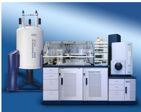
Figura 4. Equipo de resonancia magnética nuclear utilizado para el procesamiento de muestras durante los análisis de perfiles metabolómicos.
