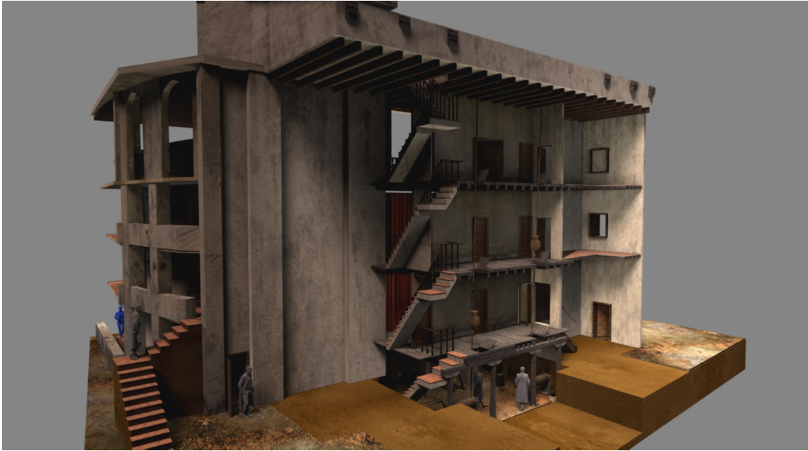
Imagen XIV. Accesos desde los laterales en el nivel del tablado y sus galerías
