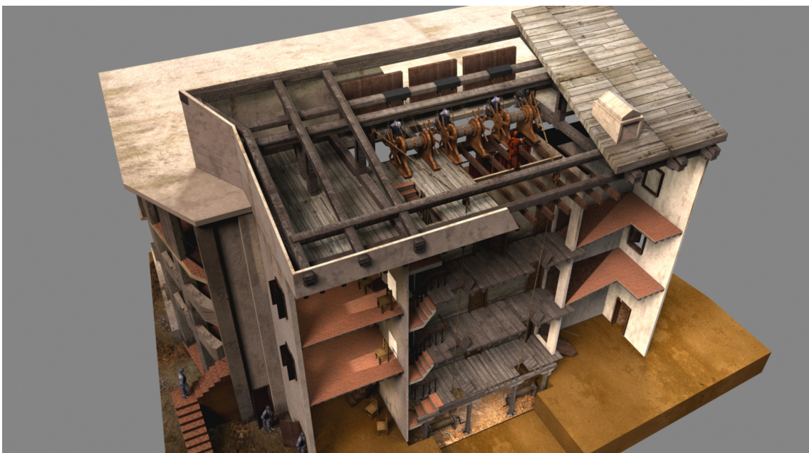
Imagen XV. Desván para el alojamiento de mecanismos que permitieran mover la maquinaria escénica para descensos y elevaciones de tramoyas complejas
