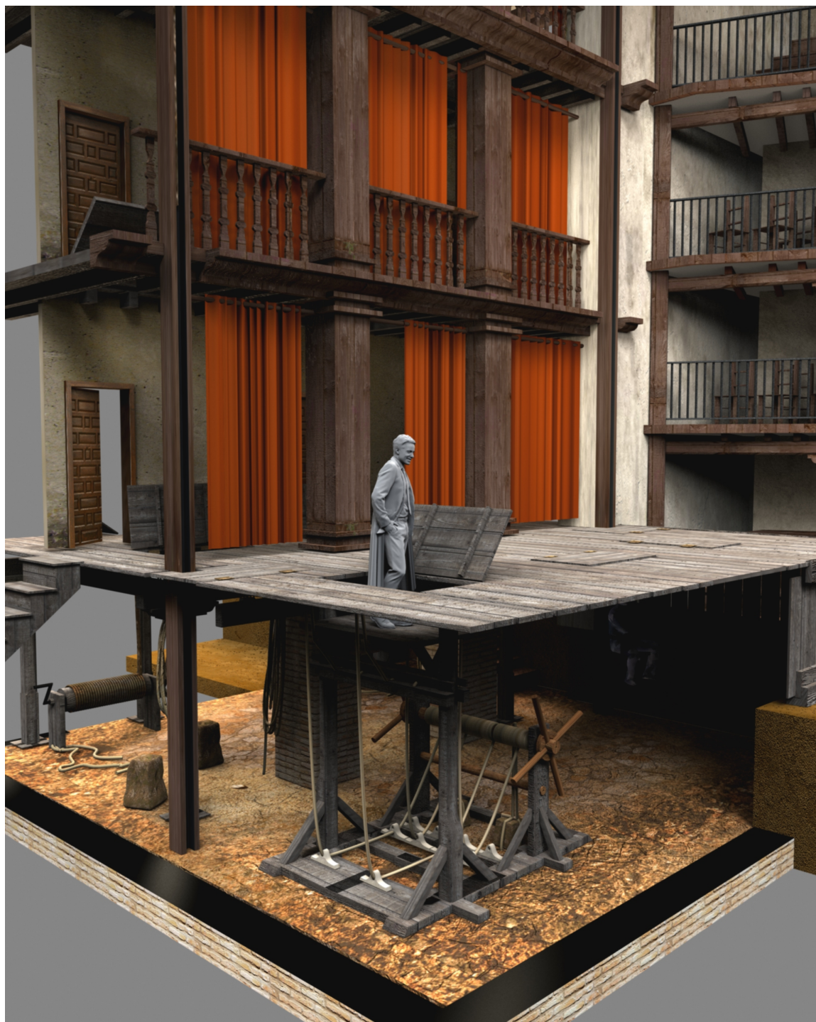
Imagen XVIII. Elevador situado en el foso
