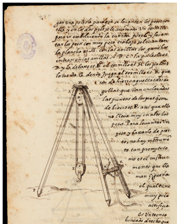
Imagen XLV. Cabra o cabrilla (Juan de Lastanosa, Los veintinueve libros de los ingenios y de las máquinas , 5 tomos, cód. ms. atribuido durante mucho tiempo a Juanelo Turriano (Madrid, Biblioteca Nacional de España, Mss/3372-Mss/3376, t. IV, fotogr. 834: Biblioteca Digital Hispánica)
