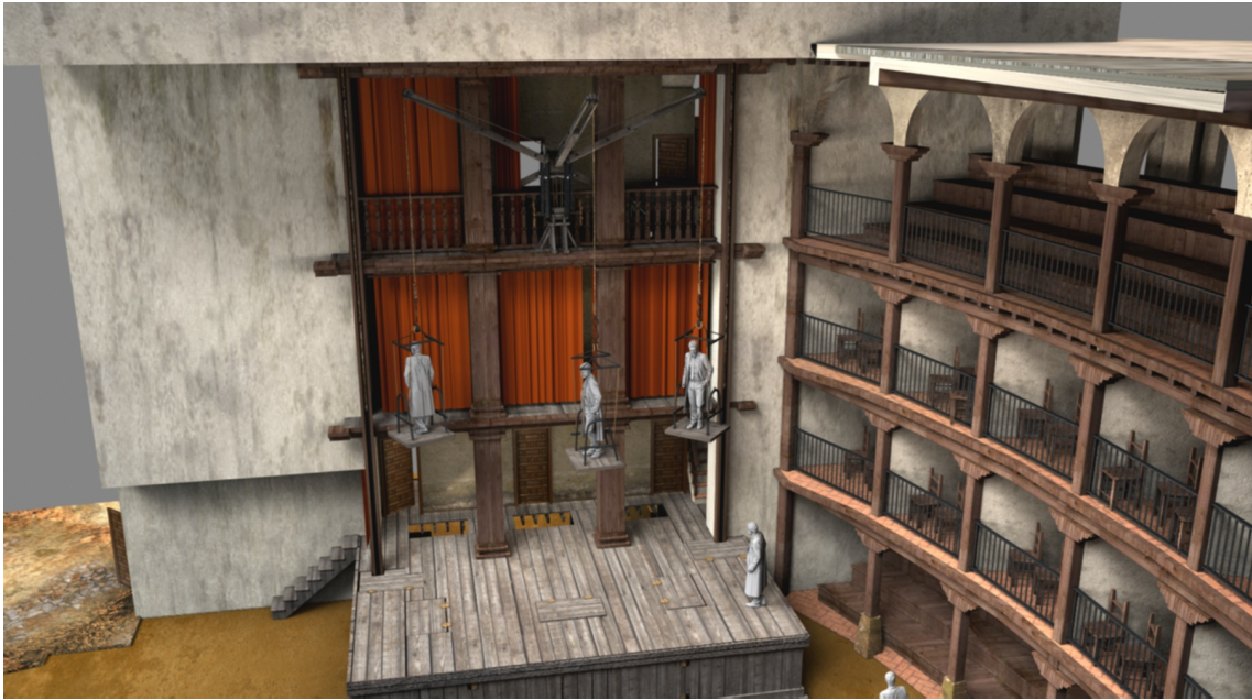
Imagen XLVIII. Grúa con desplazamiento vertical y lateral horizontal hacia un hueco y hacia otro del frente escénico
