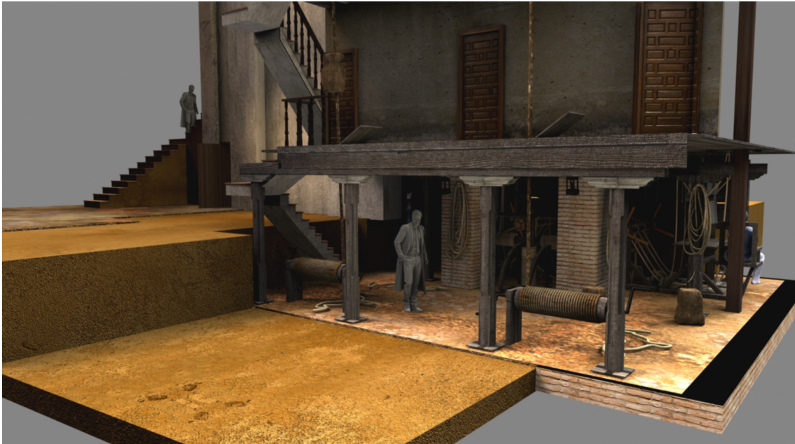
Imagen XXI. Torno para el movimiento de la canal, situado en el foso en vista posterior
