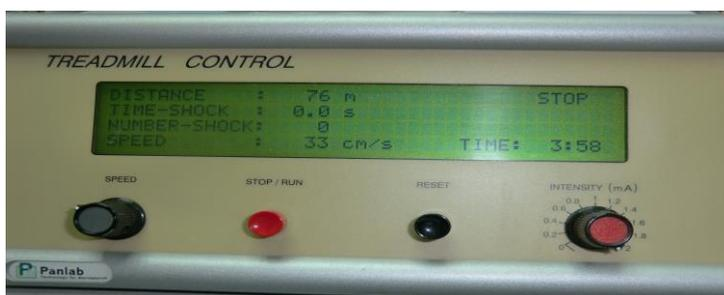
Figura 2.3.A. Sistema de control del tapiz.
