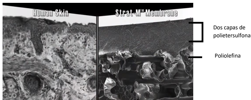
Figura 14. Comparación de la estructura de la piel humana y la membrana Strat-M ® . 201
