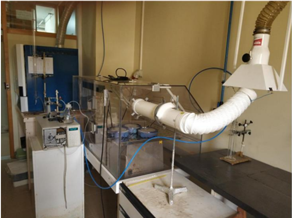
Figura 19. Fotografía de la cámara de simulación empleada para la generación de una atmósfera controlada.
