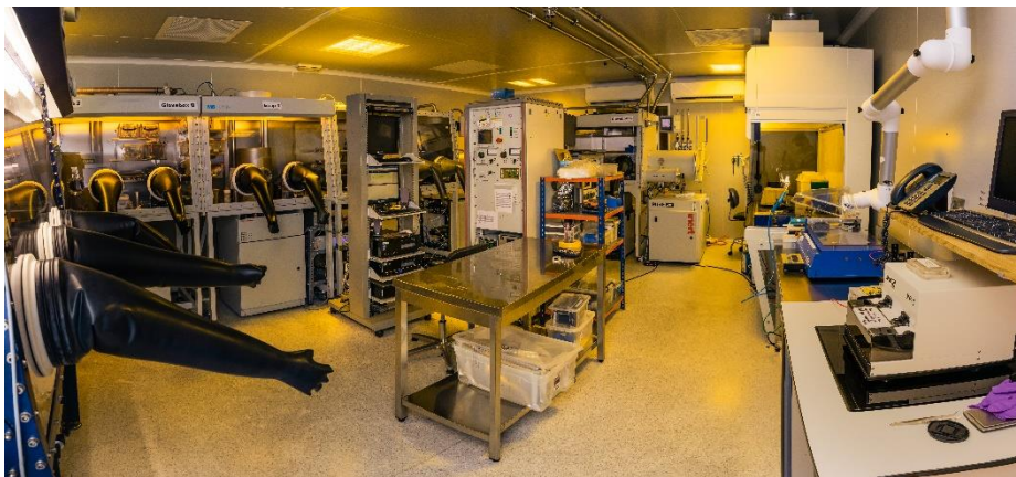
Figure 13. Class 10000 clean room situated in Instituto de Ciencia Molecular (ICMol) of the Universitat de València.
