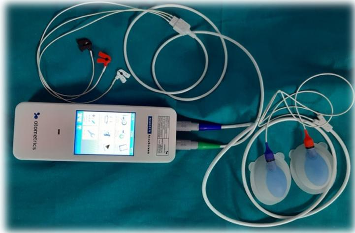
*Ilustración 10. Equipo portátil Accuscreen (Otometrics) para realizar cribado auditivo tanto con OEA como PEATCa utilizado en Hospital Universitario La Fe.*
