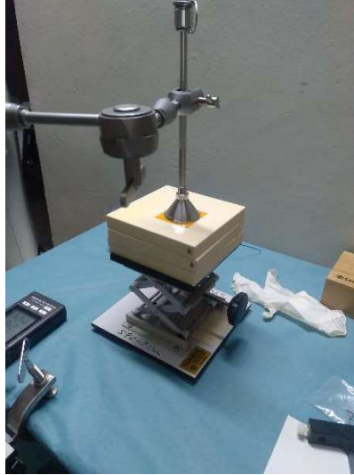
Figura 13: Configuración de medida para calibración de películas con aplicador de 50 mm.
