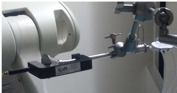
Figura 11: Medida de la dosis absorbida de referencia en aire con Axxent y ExRadin A20.
