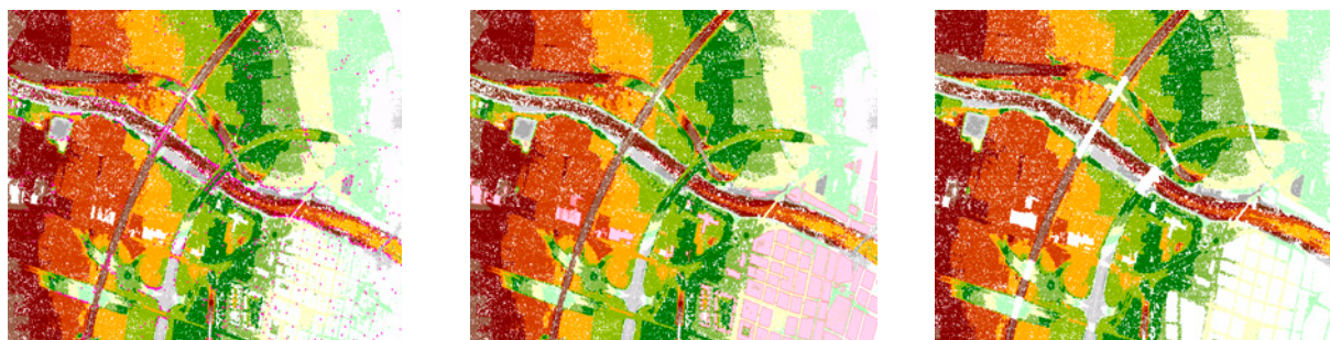
Figura 4. Tratamiento de puntos anómalos, edificios y estructuras. Limpieza del cauce a partir de secciones transversales. Fuente: elaboración propia.
