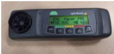
Figura 28. Dispositivo espirométrico. Figura 28_A: Espirómetro Spirobank SN A23-040; Figura 28_B: Filtro desechable Vitalograph Model No.2820 BV.
