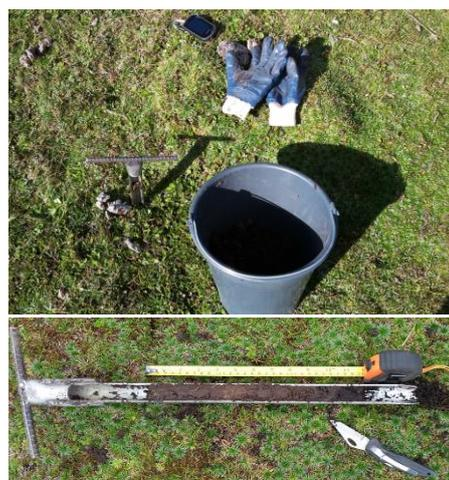
Figura 2.8: Toma de muestras del suelo aplicando el método del barreno
