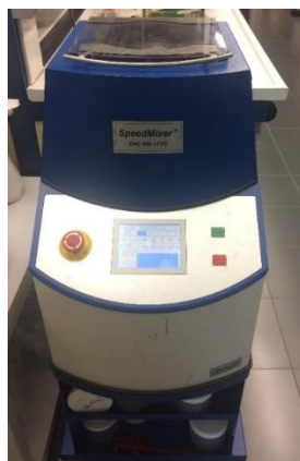
Figura 3.3. Speed Mixer™ Dac 600.1 FVZ utilizado en la segunda etapa en la síntesis de poliuretanos.
