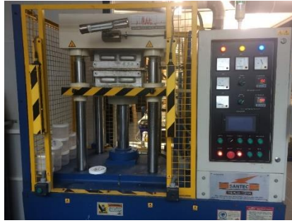
Figura 3.4. Prensa hidráulica utilizada para la síntesis de placas de poliuretano.
