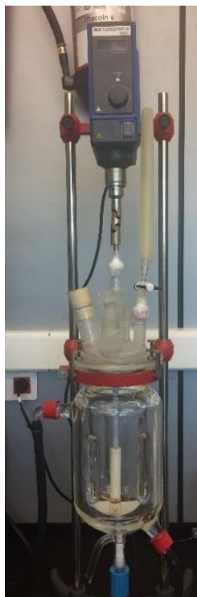
Figura 3.2. Reactor utilizado en la síntesis de prepolímero, provisto de control de temperatura, entrada y salida de nitrógeno y agitador.
