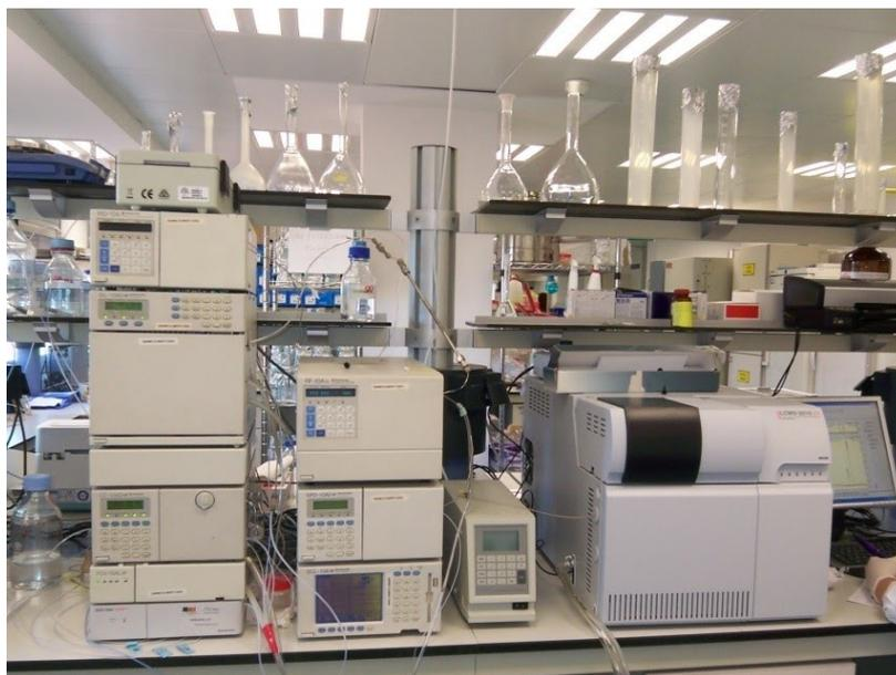
**Figura 31:** Equipo de cromatografía líquida de alta resolución (Shimadzu) empleado para la determinación de anidulafungina por fluorescencia.
