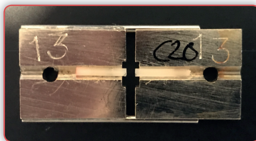
Fig. 9. Placa de tracción, con la varilla una vez ha sido ensayada.
