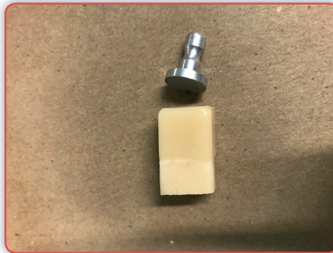
Fig. 4. Bloque de IPS e.max CAD® unido al cubo de composite antes de volver a unir la peana metálica.
