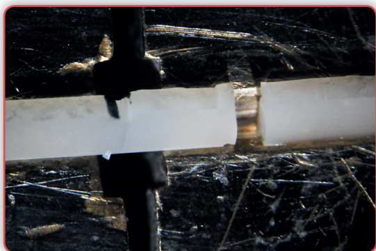
Fig. 14. Fractura cohesiva de composite.
