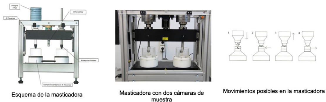
FIGURA 27. Masticadora utilizada en los ensayos de carga dinámica
