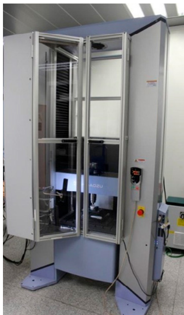
FIGURA 29. Máquina de ensayos universal Shimadzu® AG-100 KN (Shimadzu corporation, Kyoto, Japón).
