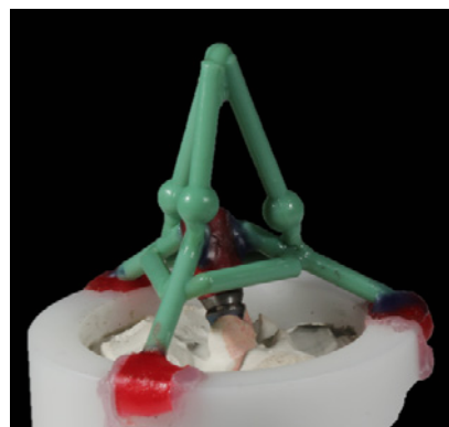
Fig. 19a. → Patrón de cera de la llave con la angulación de 30\pm 2^\circ requerida por la norma ISO-UNE 14801:2007, para su posterior colado.
