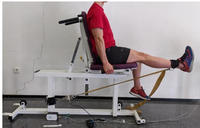
Figura 3. Evaluación mediante el uso de galga de fuerza para el cálculo de la resistencia ofrecida por la banda elástica en todo el rango de movimiento y los TUT en un ejercicio de extensión de cuádriceps. Fuente: Elaboración propia.
