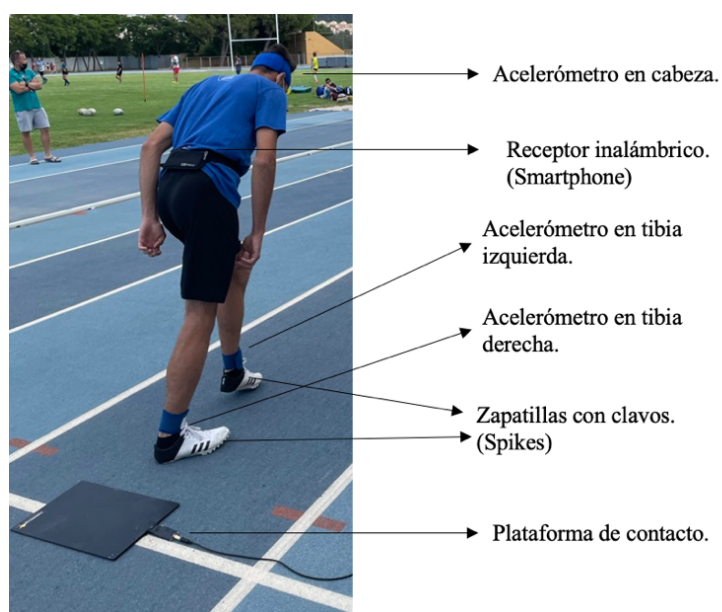
Figura 16. Atleta con la instrumentación puesta durante el muestreo (Elaboración propia).
