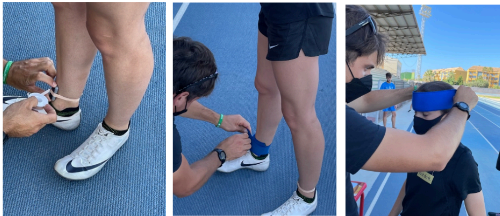
Figura 15. Ajuste de los acelerómetros en tibia y en cabeza.
