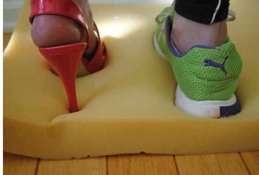
Figura 29: Presión ejercida sobre una capa de gomaespuma por una persona con un tacón y con una zapatilla de suela plana, puede apreciarse la diferencia en la profundidad de la gomaespuma en función del calzado.
