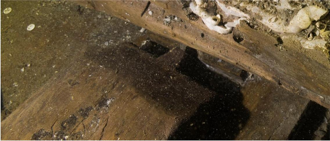
Fig. 51 – Vista superior de la junta de carpintería por rayo de Júpiter que una quilla y codaste (Archivo MAC-CASC).
